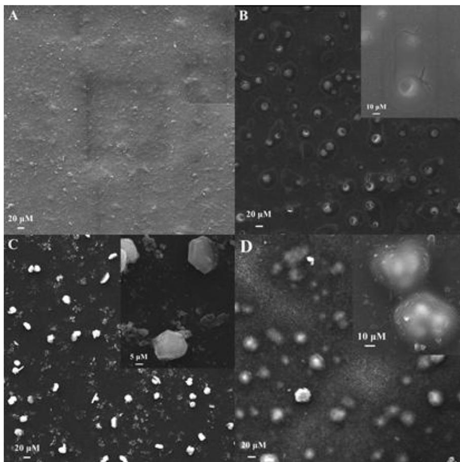
**Figure 1.** SEM images of (a) PEDOT:PSS-Nafion, (b) HRP/PEDOT:PSS-Nafion, (c) AgNPs/PEDOT:PSS-Nafion, (d) Nafion/AgNPs/HRP/PEDOT:PSS-Nafion composite films.
