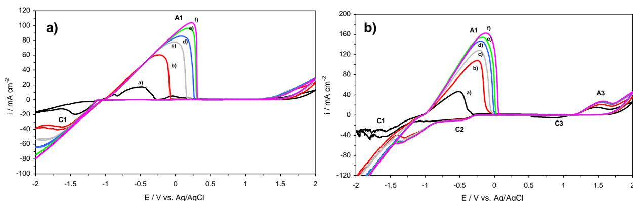
**Figure 5. a):** Cyclic voltammograms of a 0.055M  $\text{ZnCl}_2$  solution at different rotation rates: a) 0rpm; b) 500rpm; c) 1000rpm; d) 1500rpm; e) 2000rpm; f) 2500rpm. **b):** Cyclic voltammograms of a 0.055M  $\text{ZnCl}_2$  in 0.05M HCl solution at different rotation rates: a) 0rpm; b) 500rpm; c) 1000rpm; d) 1500rpm; e) 2000rpm; f) 2500rpm.
