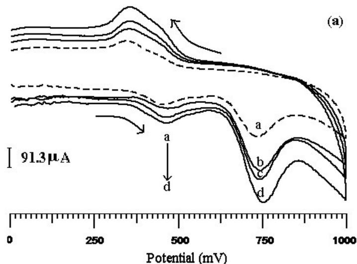
**Figure 3a.** Cyclic voltammogram of  $1 \times 10^{-3} \text{ M}$  Bromothymol blue at CPE (a) Bare CPE (b)  $5 \times 10^{-5} \text{ M}$  CTAB (c)  $5 \times 10^{-5} \text{ M}$  TX-100 (d)  $5 \times 10^{-5} \text{ M}$  SDS Surfactant immobilised at carbon paste.
